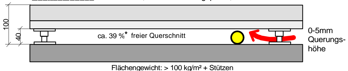
Hohlraumboden: 60'er Raster, 20mm Schalungsplatte, 40mm Estrich
